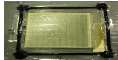
ب) نمونه پس از روشن شدن پمپ خلأ و مکش رزین‌های اضافی
