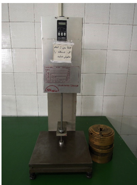
شکل ۵- دستگاه ضخامت‌سنج Shirley.
