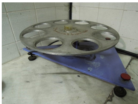
شکل ۸- اندازه‌گیری نفوذپذیری بخار آب به‌روش فنجان‌ی.
