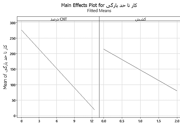
شکل ۱۳ تأثیر متغیرهای فرایندی بر روی کار تا حد پارگی (TPU/PVDF/MWCNT)
