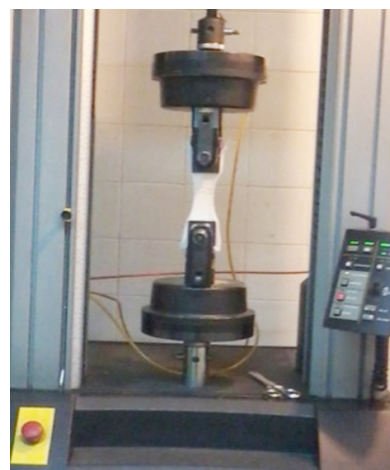
شکل ۳- دستگاه آزمون کشش، Instron مدل ۵۵۶۶.
