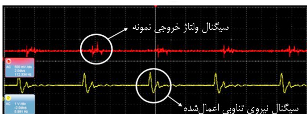
شکل ۲- سیگنال خروجی آزمون پیزوالکتریک نمونه PVDF.
