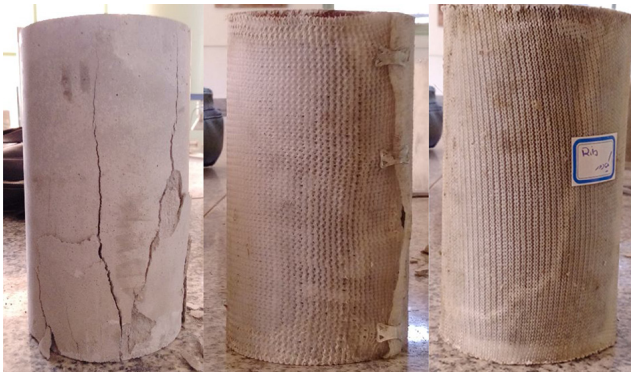
شکل ۹- نحوه شکست نمونه‌ها.
