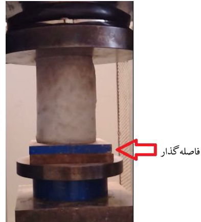
شکل ۶- قرارگیری نمونه‌ها میان دو فک.
