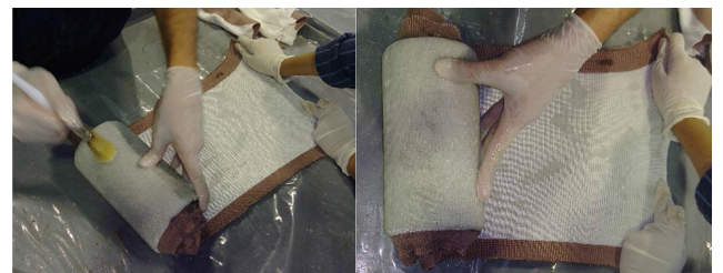
شکل ۴- رزین‌زنی و دورپیچی ستون‌های بتنی.
